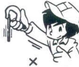
**No levante un objeto con el micrómetro**
